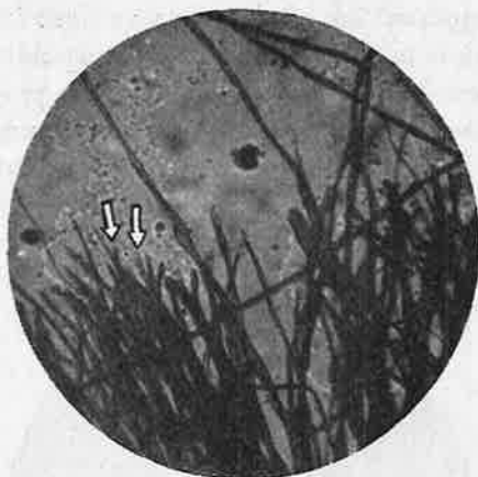
FIG. 11 et 12. Fil tendu, couteau émoussé. Comparé à fig. 7, dentelure moins forte et plus régulière.
