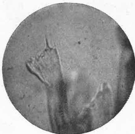
FIG. 7 et 8. Fil détendu, couteau émoussé . Forte dentelure irrégulière des extrémités, correspondant à la dentelure de la lame.
