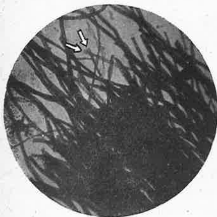
FIG. 9 et 10. Fil tendu, couteau aiguisé . Elargissement minimal et régulier des extrémités. Le fil montre une coupure relativement nette (la fig. 10 montre nettement la partie coupée et celle où les fibres affaiblies par la tension se sont déchirées d'elles-mêmes).
