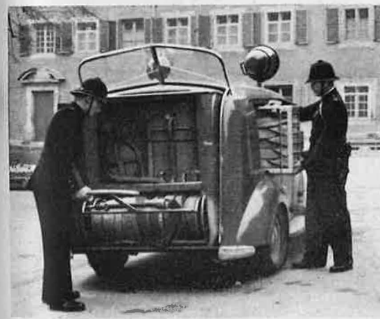
FIG. 2 — Voiture de premiers secours en cas d'incendie.
