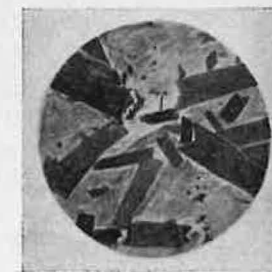
Poussières ferrugineuses vues au microscope
